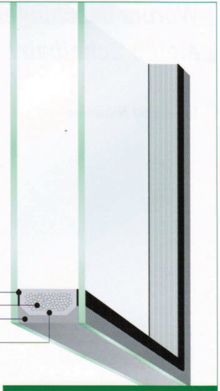
Schematischer Aufbau von Zweifach-Isolierglas
